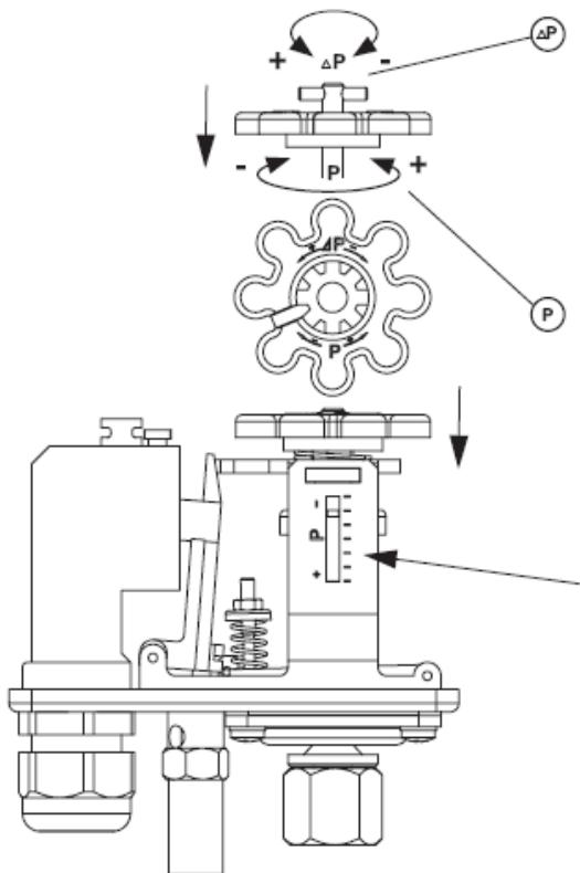
Nastavení vypínacího tlaku se provádí kovovým kolíkem a jeho otáčením ve směru + P nebo - P při neotáčejícím se stlačeném plastovém kotouči.
